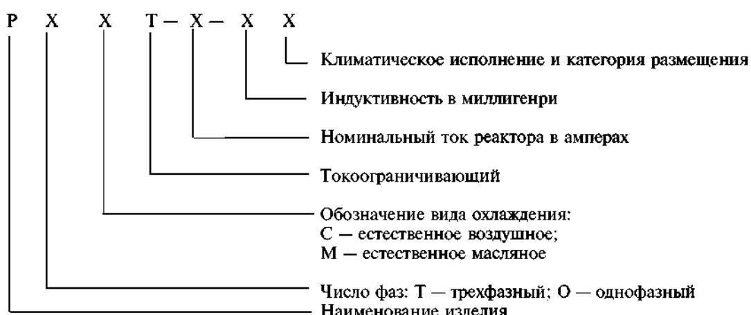
Пример условного обозначения трехфазного токоограничивающего реактора с естественным воздушным охлаждением на ток 820 А, индуктивность 0,5 мГ, климатического исполнения У, категории 4:
